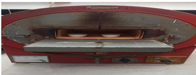
**Figure 39:** Calcination des échantillons au four à moufle
