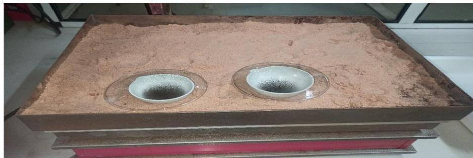
**Figure 42:** Etape de placement des échantillons dans le bain de sable
