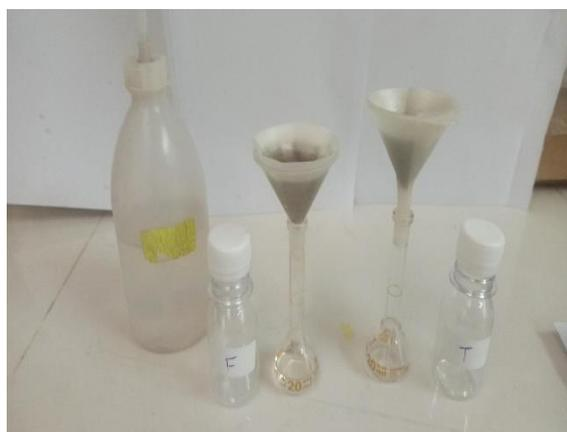
**Figure 44:** La filtration et la récupération des solutions d'échantillons
