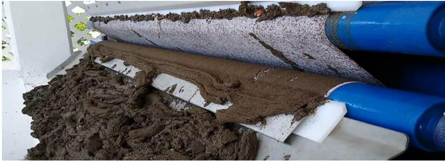
**Figure 22 :** Déshydratation Mécanique des boues par filtre à bandes (EMO France)
